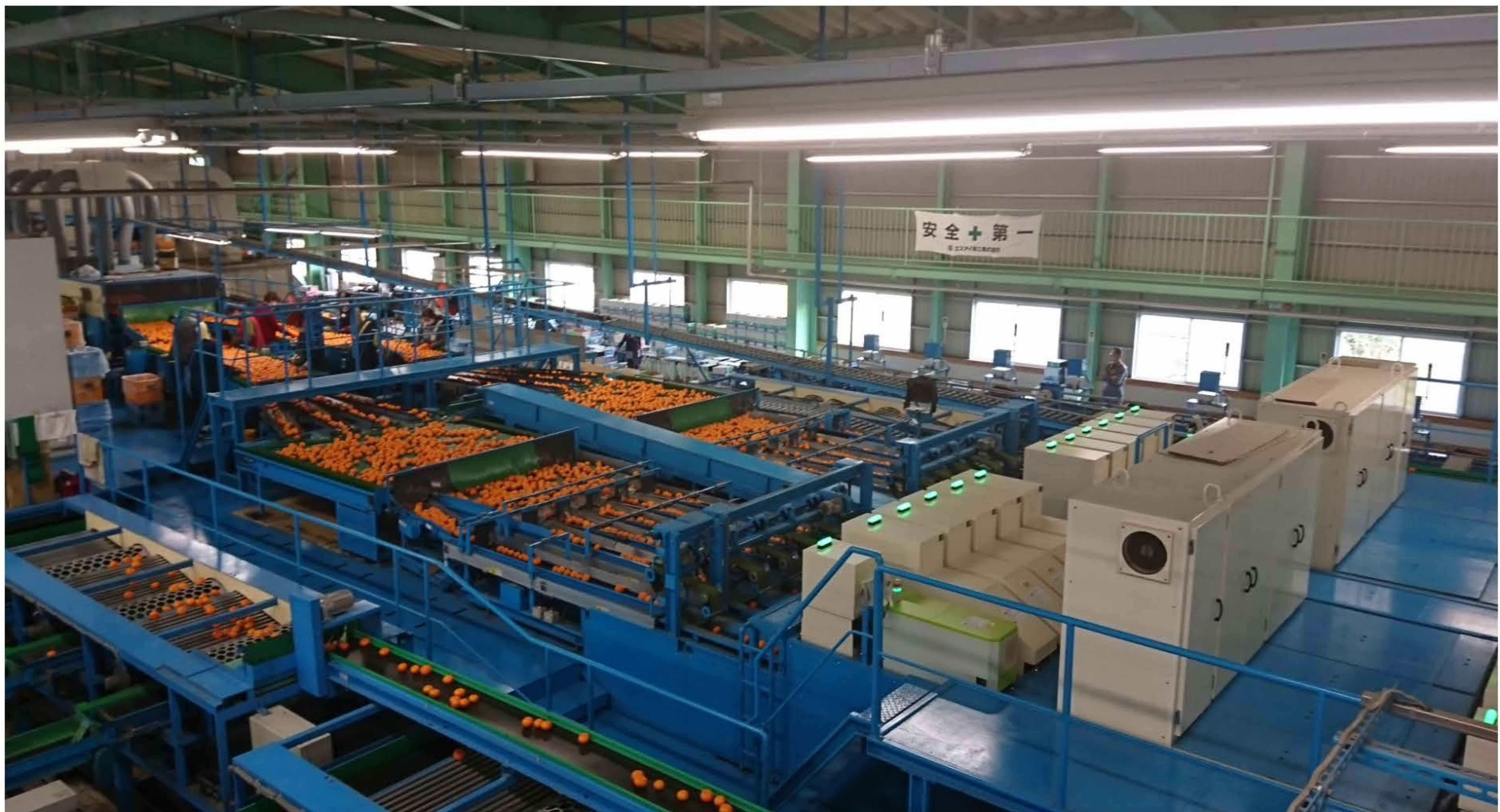
共同研究を行った長崎県のみかんの選果場。ここでは、出荷される全てのみかんの糖度を光センサーで計測しており、電子データとして蓄積されています。
