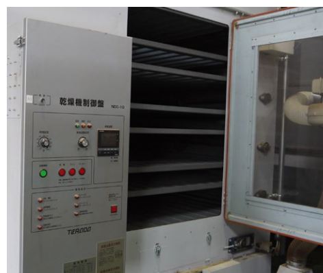
乾燥機で温風を利用し、水分が約5%程度になるよう茶葉を乾燥させます。この工程により茶葉は長期の貯蔵に耐えるようになり、さらにお茶特有の香味が生まれます。
