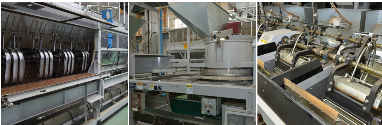
左から粗揉機械／揉捻機械／精揉機械。
