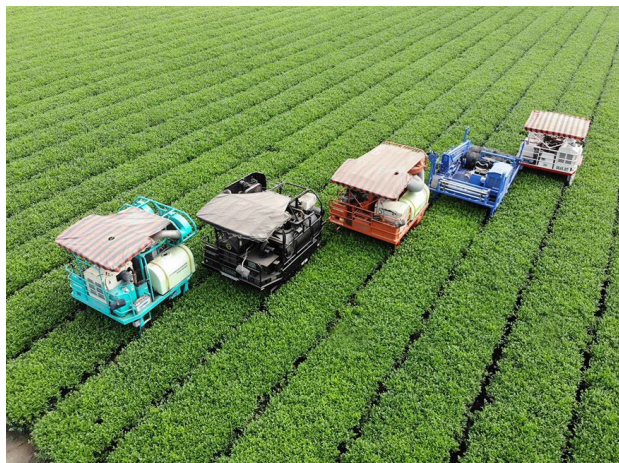
水と風で害虫を吹き飛ばす「ハリケーンキング」、雑草を蒸気で除草する「スチームバスター SL」などのオリジナルマシンを運用中。 (写真提供／鹿児島堀口製茶(有))
