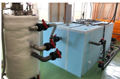
牛のルーメン液を活用したメタン発酵装置。
