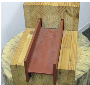
集成材被覆鉄骨 断面 (mm) : 240×240
