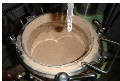
ウッドストローの製作過程の様子。左から、木粉・増粘剤混練（こんれん）前、木粉・増粘剤混練後、成形。
