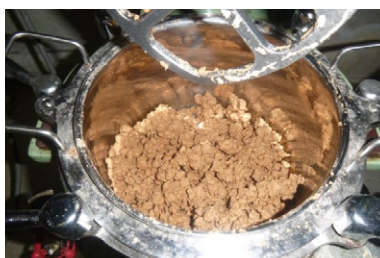
ウッドストローの製作過程の様子。左から、木粉・増粘剤混練（こんれん）前、木粉・増粘剤混練後、成形。
