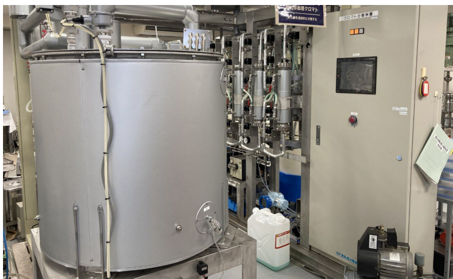
疑似移動層方式のクロマトグラフィー分離装置
