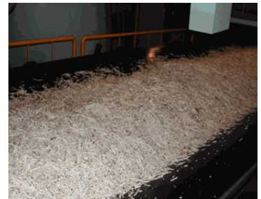
裁断後のてん菜。4mm～5mm幅に細長く裁断されたてん菜は、「コセット」と呼ばれます。
