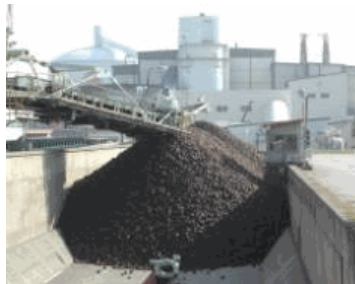
集めたてん菜をビートビンに投入。この後、水流に乗せて、洗いながら工場内へ流し込みます。
