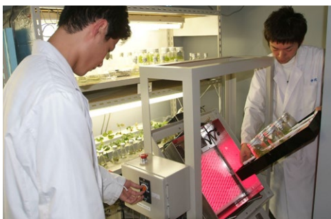
3-Dクリノスタット（疑似微小重力植物栽培装置）。
