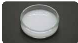
4: さらに竹セルロースをナノ化してCNFをつくります。
