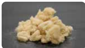
2: 伐採した竹の皮をむき、つぶしてから圧力鍋で煮て竹綿を製造します。
