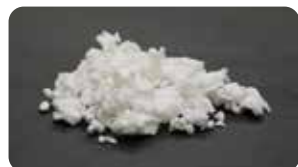
3: 竹綿に化学薬品で処理を加え竹セルロースを作ります。
