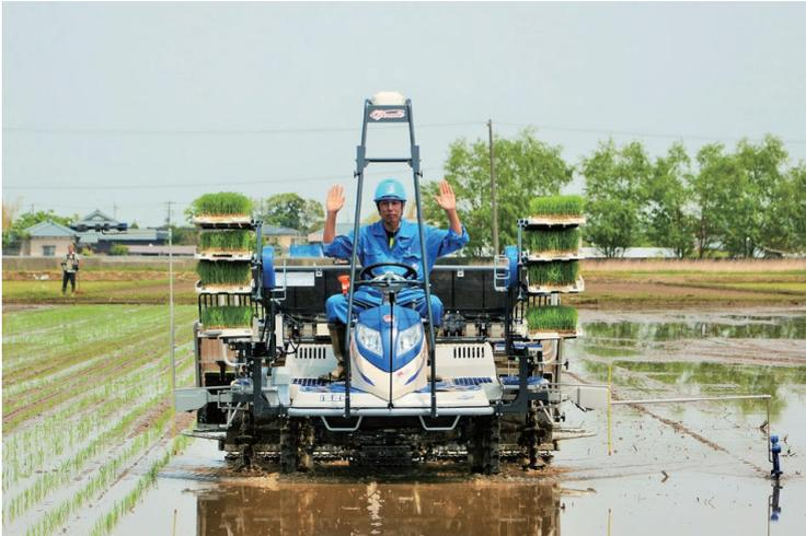
田植え作業の負担軽減が図られたり、運転が慣れていない人にも簡単な操作だけで自動直進ができる“直進アシストシステム”を搭載した田植機。
