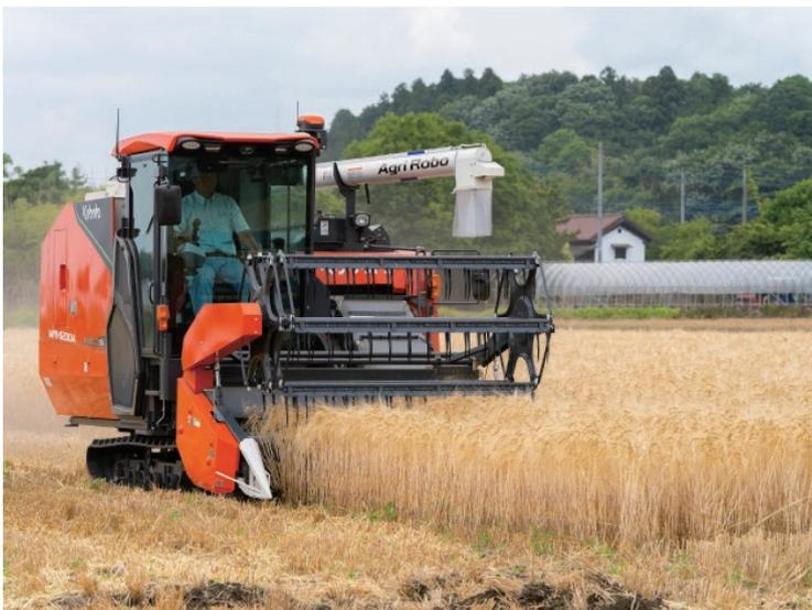
業界初となる自動運転農機「アグリロボコンバイン WRH1200A」は、これまで経験と技術が必要だった、コンバインの運転を簡単にすることに成功しました。複数のレバーやボタンを操作することなく、運転に慣れていない人でもオペレーターとして搭乗するだけで、稲や麦を収穫できます。
