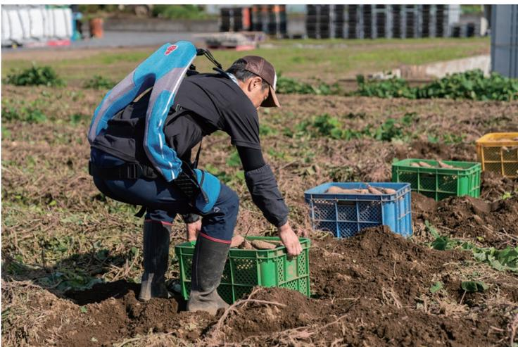
「マッスルスーツ Every (エブリイ)」は、腰部の補助に特化した装着型のアシストスーツです。空気圧式人工筋肉の働きによって装着者の動作を補助。重い物を持ち上げるときや中腰姿勢を続ける際、腰の負担を軽減するとともに、農作業の環境向上に貢献します。
