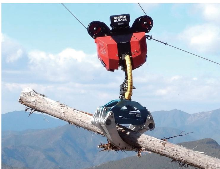
急傾斜地での木材生産では、ワイヤーロープで木材を吊して運搬する「架線集材」が行われていますが、切れたワイヤーの跳ね返りなどの危険があります。
