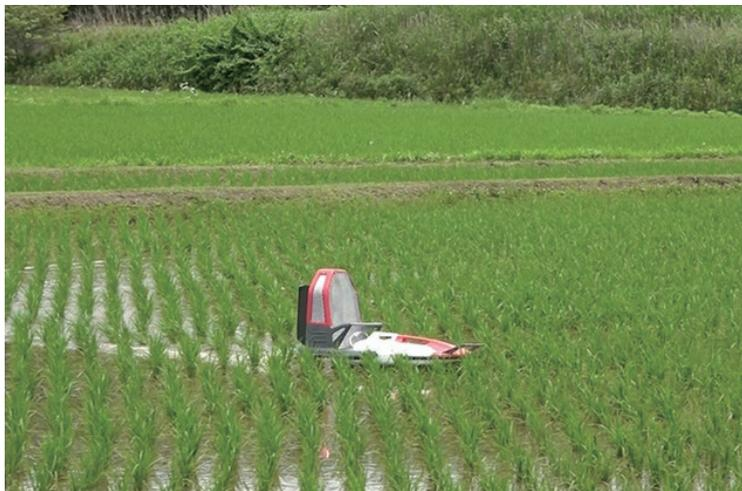
水田での作業を効率化する「TB02」は、除草剤の散布などが遠隔操作で可能な産業用小型無人ボート。軽量でコンパクトな上に、底面の形状を工夫したことで、直進時の安定性や旋回のしやすさを実現しています。
