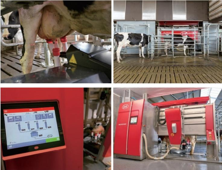
搾乳ロボット「アストロノートA5」は、牛に優しい搾乳ロボット。ロボット内は、牛がスムーズに入退出できる構造にして、開放的で広いスペースを確保。3Dカメラで牛の位置を把握し、素早くロボットアームが追従して搾乳することにより、牛を固定する必要がありません。
