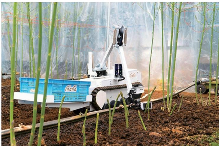
「自動野菜収穫ロボット」は、ほ場内を自動走行で移動しながら、収穫に適した頃合いの野菜のみを自動で判断して収穫を行うロボット。現在はアスパラガスに対応しており、今後はトマトやキュウリ、ピーマン、ナスなどの自動選別収穫も可能になる予定です。
