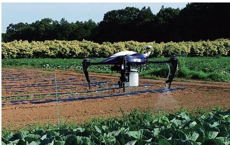
ドローンがほ場の上を飛行して、農作物を撮影。画像はAIを用いて解析され、病害虫の位置を特定し、ドローンが移動。ピンポイントで農薬を散布します。これにより、一般的な栽培方法と比較して、農薬使用量や散布労力を削減することができます。
