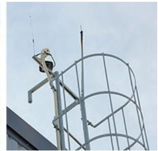
自費で設置したRTK-GNSS (GNSS:人工衛星を使って地上の現在地を計測するシステム)の基地局のアンテナ (右)。高精度の位置情報を取得するために必要な補正情報を、ロボットトラクターなどに送信する。「操作の精度を向上させるため自費で導入しました。こうした基地局の整備が進めば、ロボットトラクターの普及が進むと思います」と福原さん。
