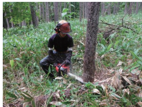
伐倒の研修にて。チェーンソーは、木に水平にかつ伐りすぎないようにする。
