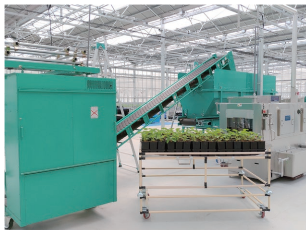
栽培ポットに培地を詰めたり、養液を混合したりする作業を機械化している。
