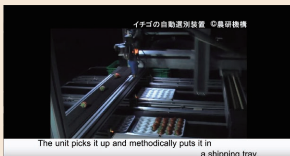
いちごのパック詰めロボット。 動画提供／農研機構
