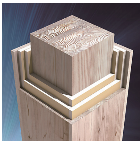
木材を石膏ボードで囲み、さらに外側を木材で覆う。
