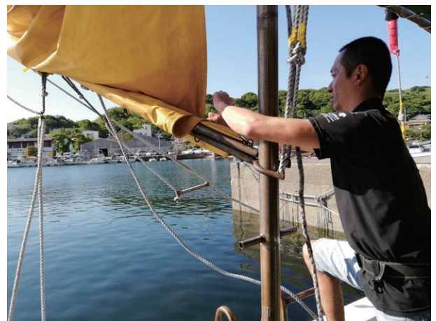
逆風でも船が安定して進むように、スパンカーで船の向きを調整する。
