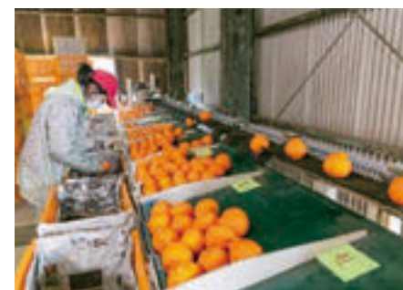
園地拡大、収穫量の増大により、手選別が難しくなったため、光センサー付きの選果機を導入。精度と酸度をセンサーで測って選別する
