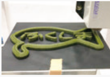
ホウレンソウ乾燥粉末を練り込んだ「魚のすり身」を圧縮空気で押し出して造形 写真提供／水産大学校
