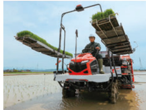
GPSや24.6馬力のディーゼルエンジンを搭載し、性能も格段に進歩 (写真はクボタの田植機「ナビセル」) 写真提供／(株)クボタ(上記2点とも)
