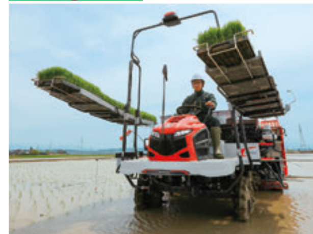
GPSや24.6馬力のディーゼルエンジンを搭載し、性能も格段に進歩 (写真はクボタの田植機「ナビヴェル」) 写真提供／(株)クボタ(上記2点とも)
