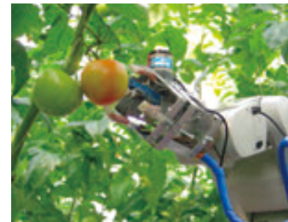
トマトやいちごなどの 大規模農園で試験運用が 始まっている「農業 収穫ロボット」
