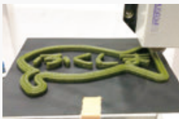
ホウレンソウ乾燥粉末を練り込んだ「魚のすり身」を圧縮空気で押し出して造形
