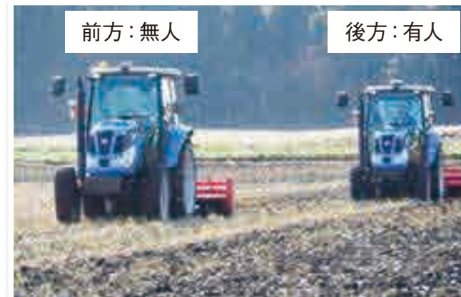
ロボットトラクタと有人トラクタによる協調作業。有人トラクタの単独作業より、作業効率が向上するため、少ない人数で大面積の作業が可能
