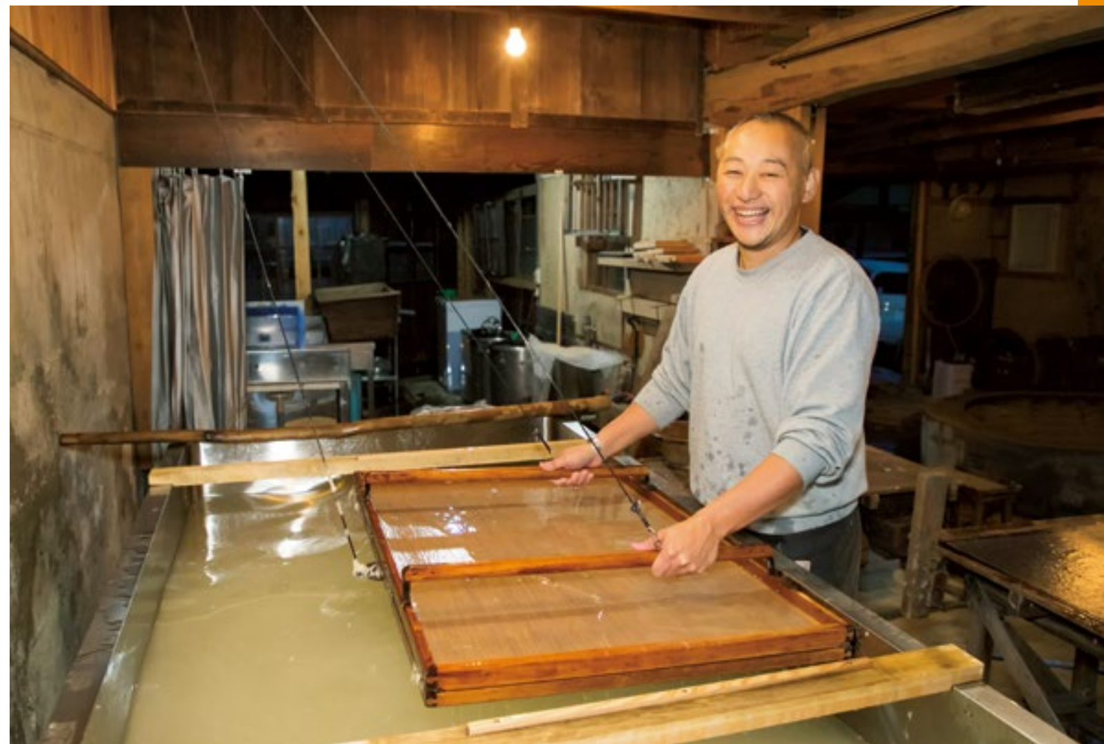
水中に楮の繊維とトロロアオイの根から出る粘液を入れて、紙を漉いていく。
