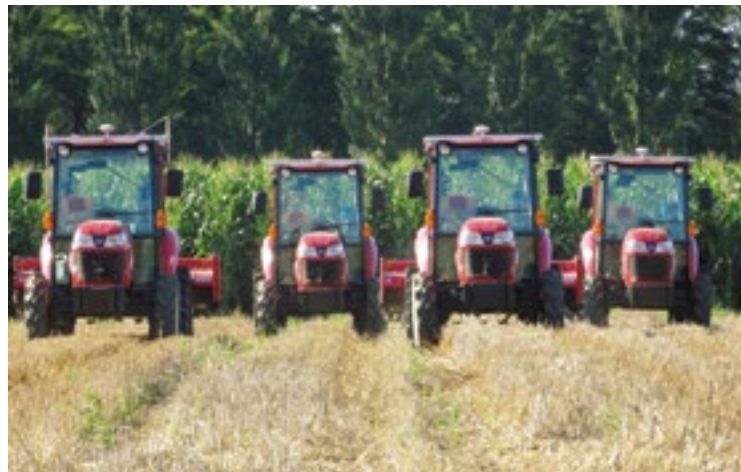
上／あらかじめ設定したコースを自動走行し、ずれたら自動的に修正。慣れた人間より正確に走行できる。 左／複数の無人農機を協調して作業させる研究も進む。
