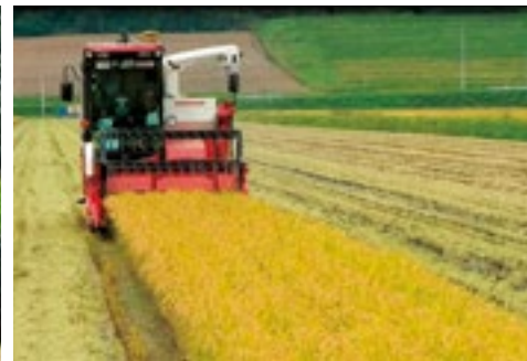
上／あらかじめ設定したコースを自動走行し、ずれたら自動的に修正。慣れた人間より正確に走行できる。 左／複数の無人農機を協調して作業させる研究も進む。
