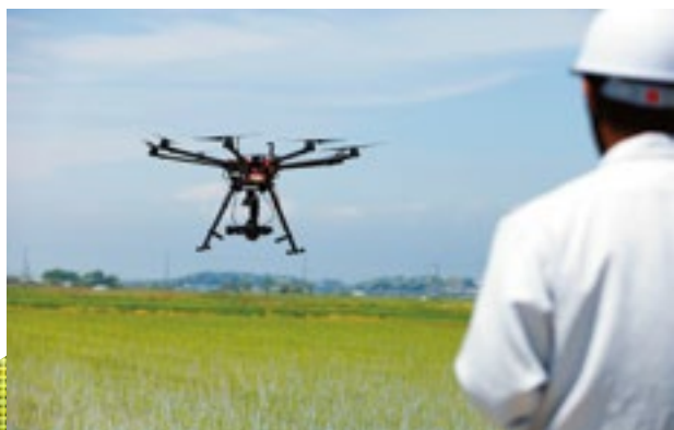
現在は高度30mから測定するが、将来カメラの解像度が上がれば、さらに高い場所から、より広い範囲を測定できるようになり作業効率上がる。
