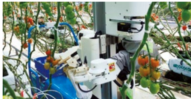
トマトにくぐらせた輪を手前に引いて切り離すロボットハンドの開発に成功した。
