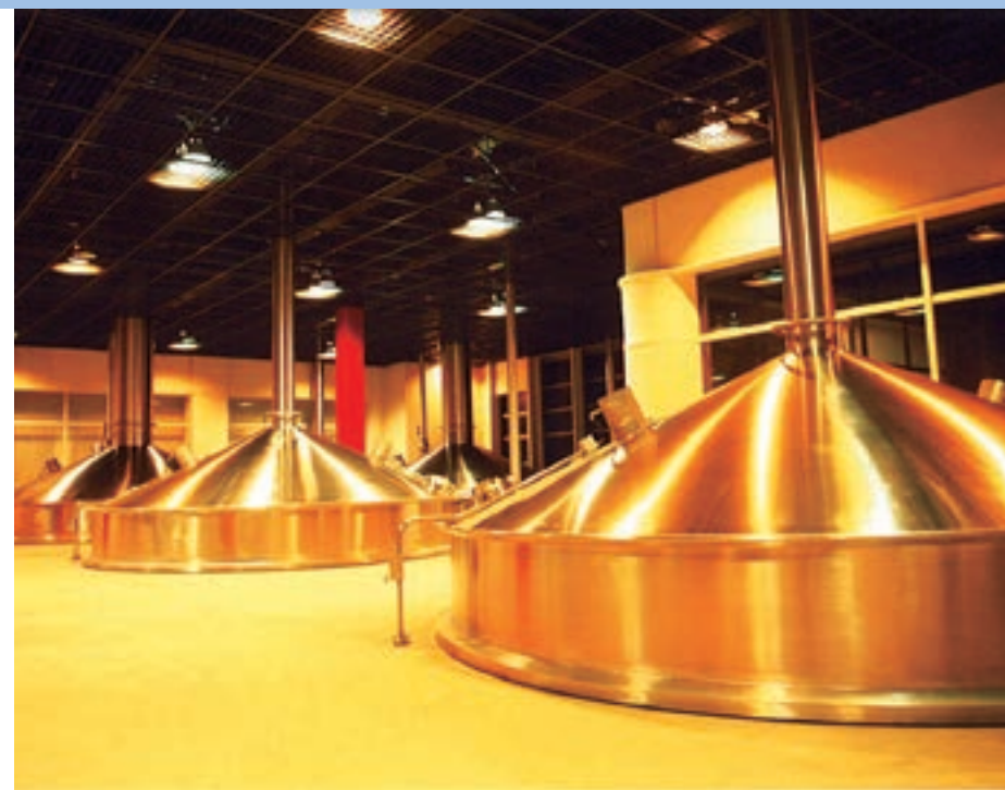
仕込み釜では、麦芽からビールのもとになる糖液である麦汁をつくる 写真提供／麒麟ビール
