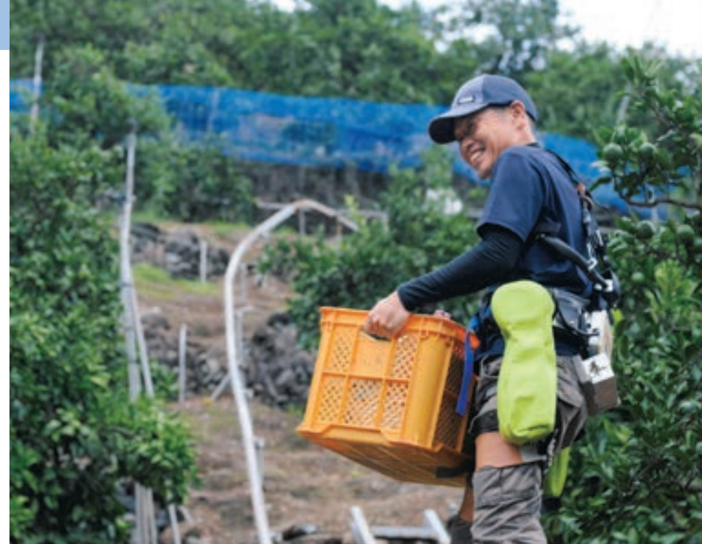
腰・股関節のサポートに特化した「パワーアシストスーツ」。荷物の持ち上げや中腰での作業、歩行の際にかかる身体への負担を軽減する
