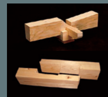
伝統木構造の継手・仕口
