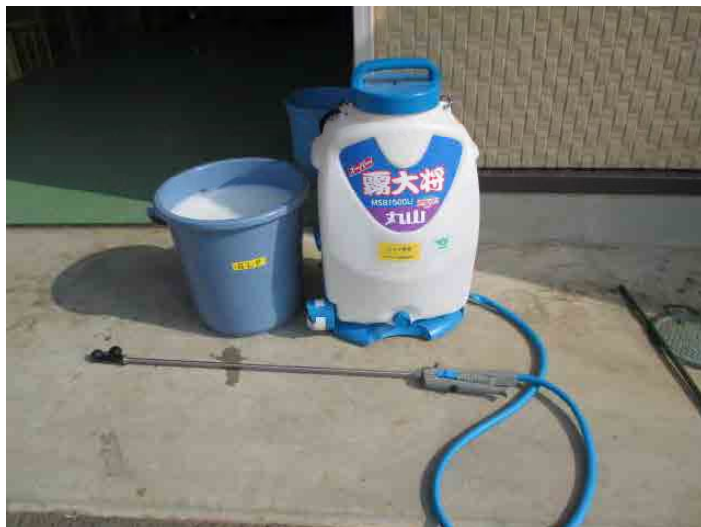
左：散布機器及び調製薬液 丸山製作所MSB1500Li 上左右：使用ノズル ヤマホ2頭口ノズル(NN-D-8Sチップ装着)
