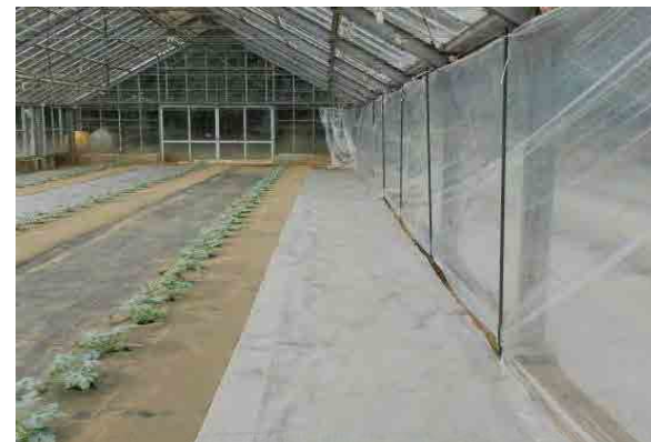
写真3. 飛散防止遮蔽幕設置状況（処理区間）
