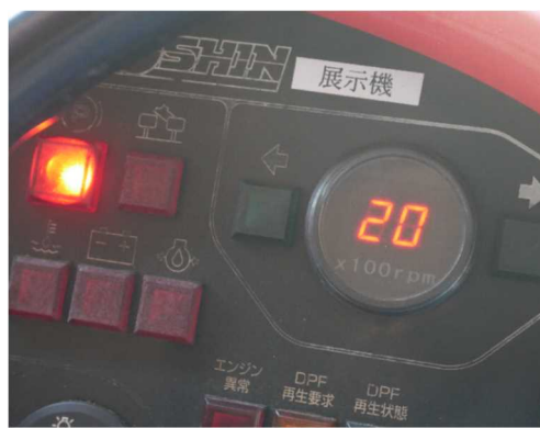
図 43 S・S の操作パネル (表示されている数字部分はエンジン 回転数 20 \times 100\text{rpm} を指示する ことを示す)
