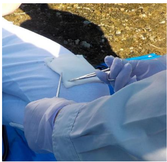
図 13 操縦者及び補助者の身体表面暴露量調査 インナーガーゼパッチ試料回収 (上段：胸部・背、中段：腕、下段：足)
