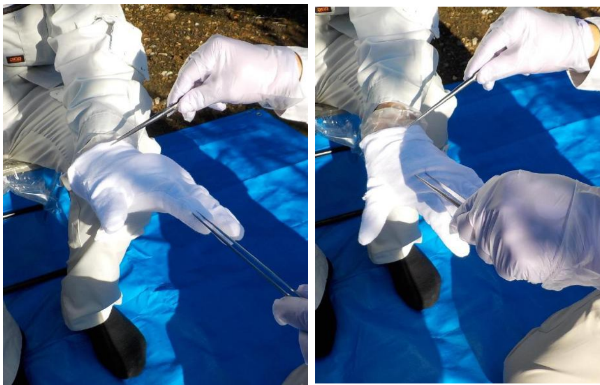
図 11 操縦者及び補助者の身体表面暴露量調査 手(手袋) 試料回収 (左：外側手袋、右：内側手袋)
