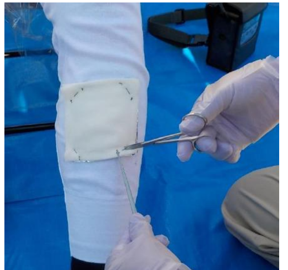
図 13 操縦者及び補助者の身体表面暴露量調査 インナーガーゼパッチ試料回収 (上段：胸部・背、中段：腕、下段：足)
