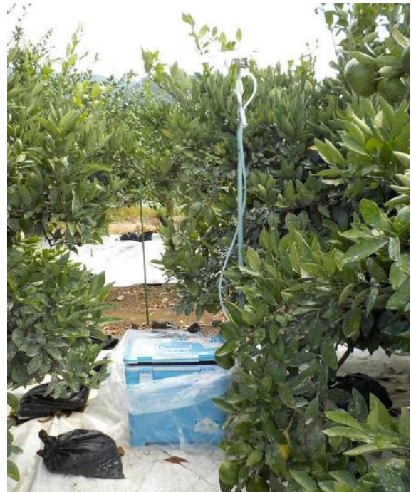
図 15 散布確認調査における気中濃度調査(左：捕集カラム、右：設置状況)
