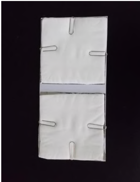
図 14 散布確認調査における付着量調査(左：調査用ガーゼパッチ、右：設置状況)
