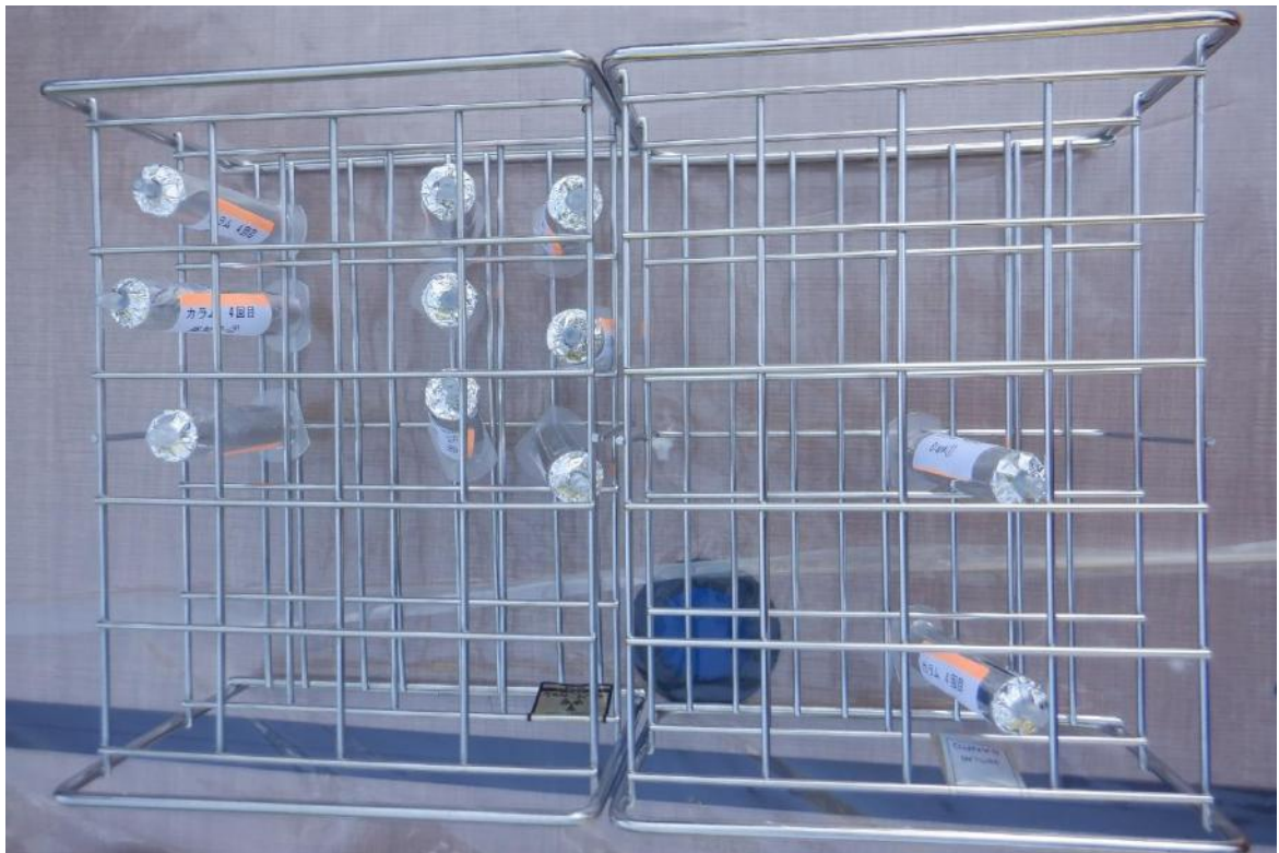
図 19 野外添加回収試験状況 捕集コラム
