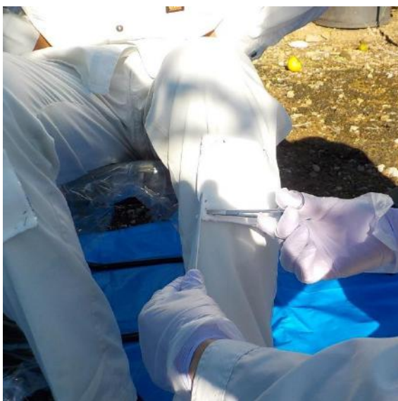
図 12 操縦者及び補助者の身体表面暴露量調査 アウターガーゼパッチ試料回収 (上段：胸部・背、中段：腕、下段：足)
