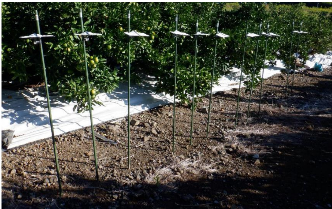
図 17 野外添加回収試験状況 ガーゼパッチ
