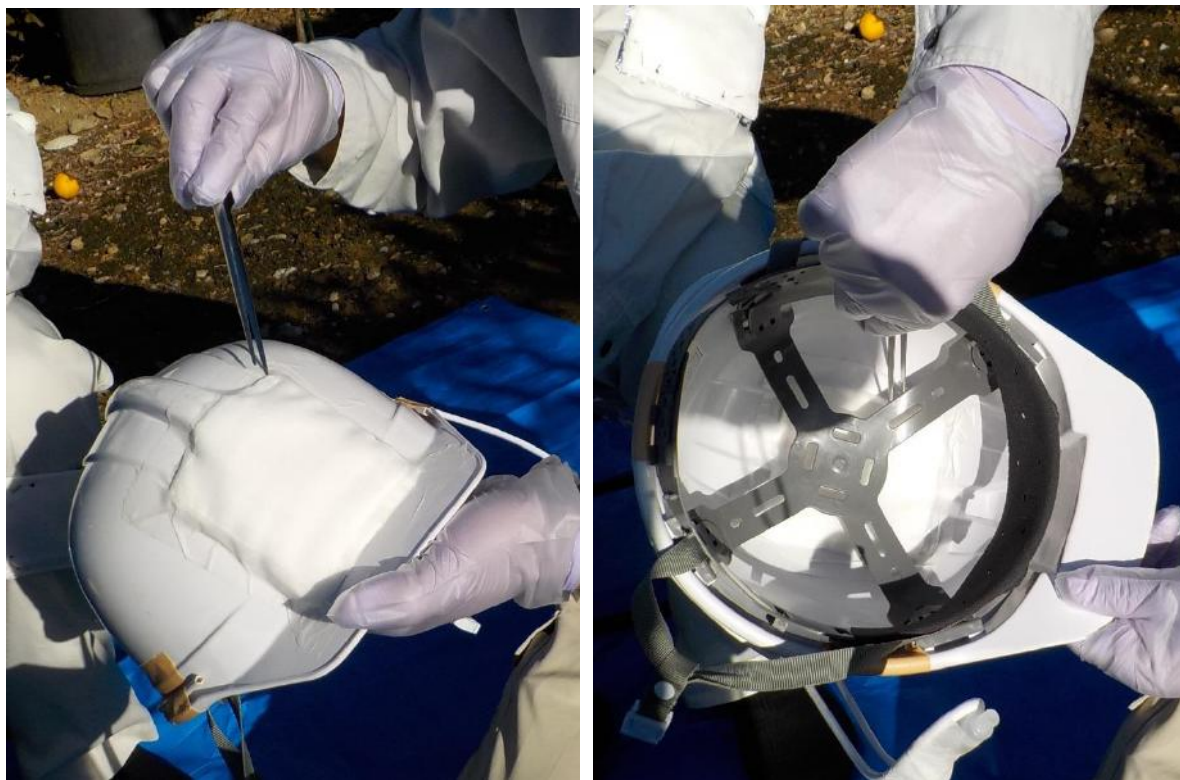
図 10 操縦者及び補助者の身体表面暴露量調査 頭(ヘルメット)試料回収 (左：表面(アウター)、右：内面(インナー))
