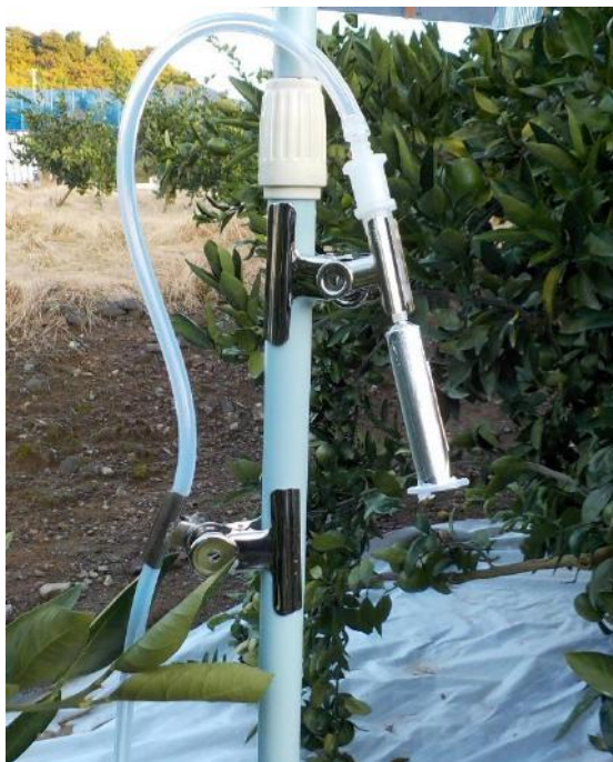
図 15 散布確認調査における気中濃度調査(左：捕集カラム、右：設置状況)
