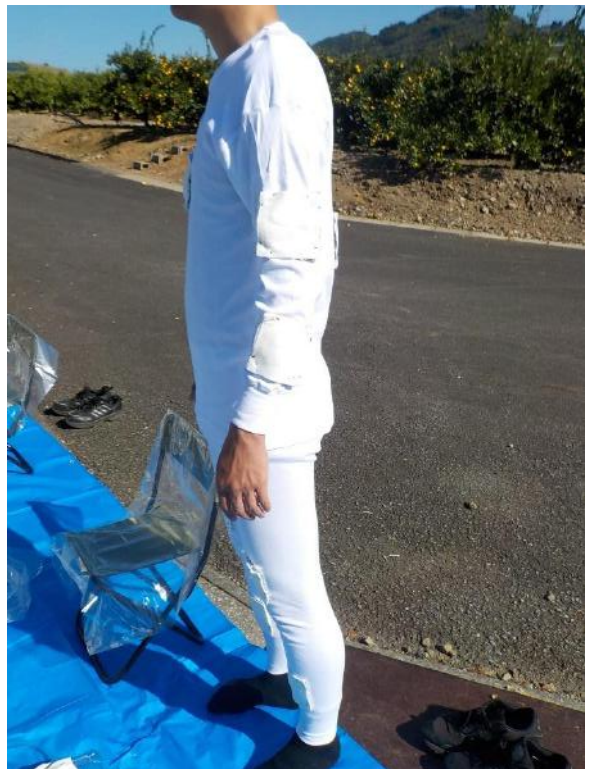
図 9-2 操縦者及び補助者の身体表面暴露量調査 調査装備（インナー）
