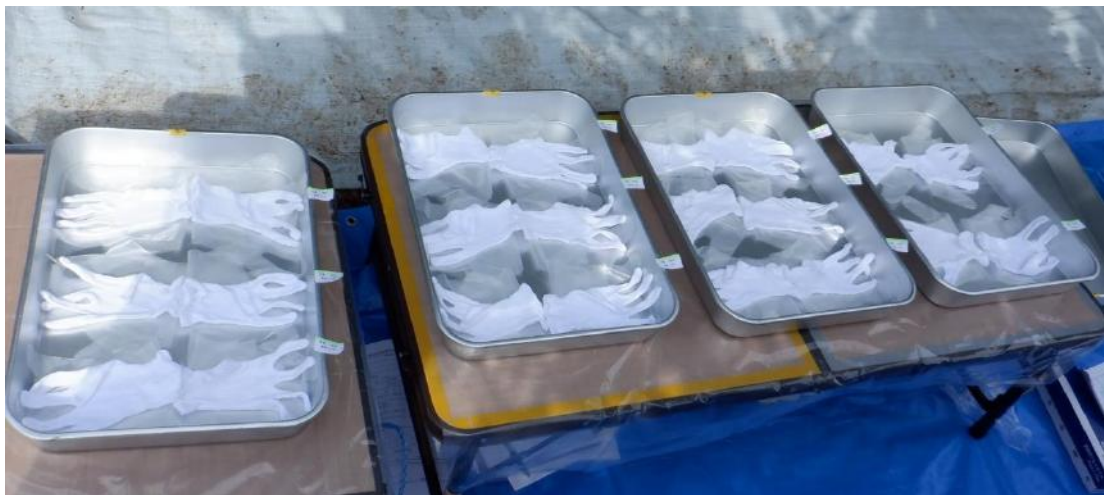
図 18 野外添加回収試験状況 手袋
