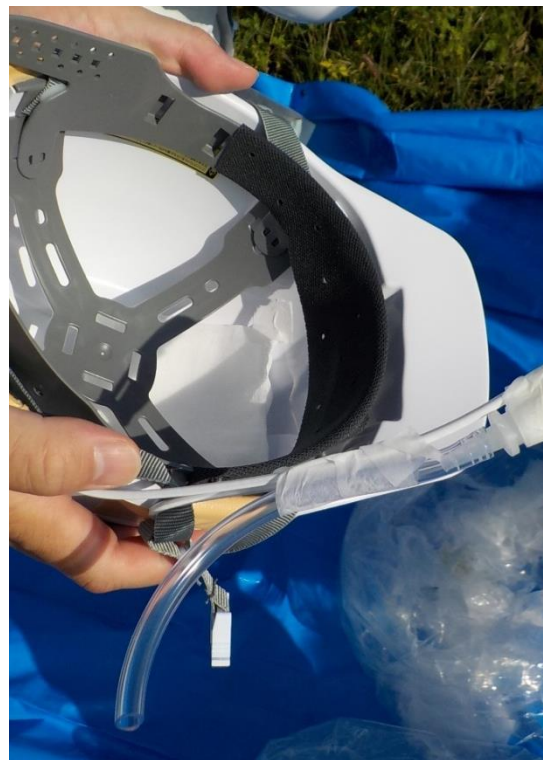
図 13 操縦者・補助者の身体表面暴露量調査 頭(ヘルメット)試料回収
