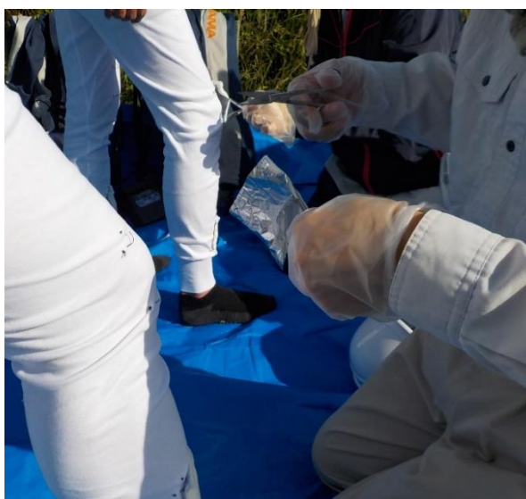
図 16 操縦者・補助者の身体表面暴露量調査 インナーガーゼパッチ試料回収
