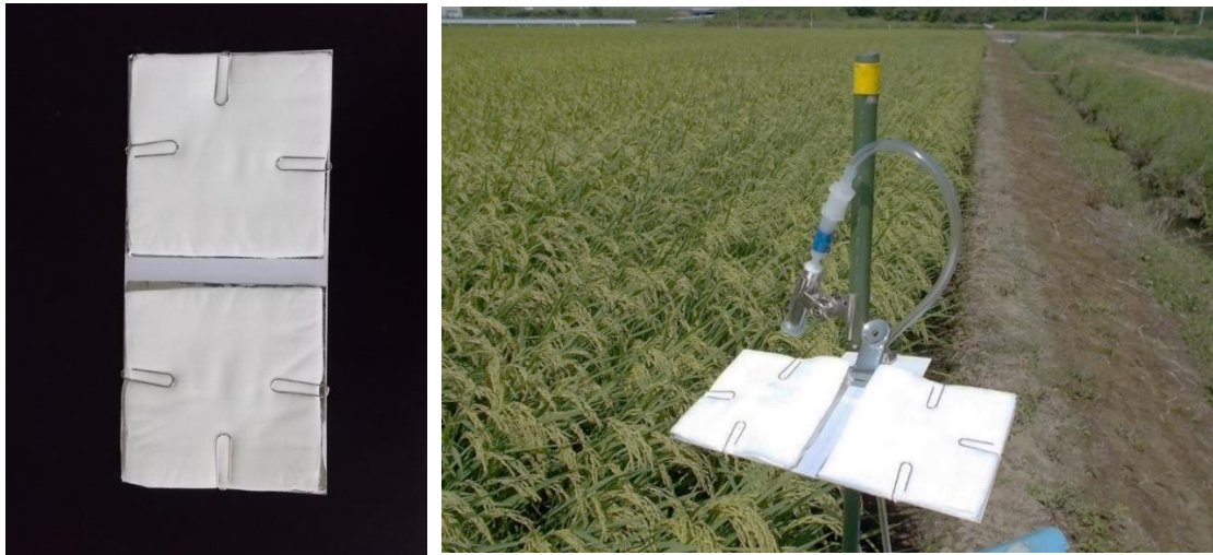
図 11 身体表面暴露量調査(左：調査用ガーゼパッチ、右：設置状況)
