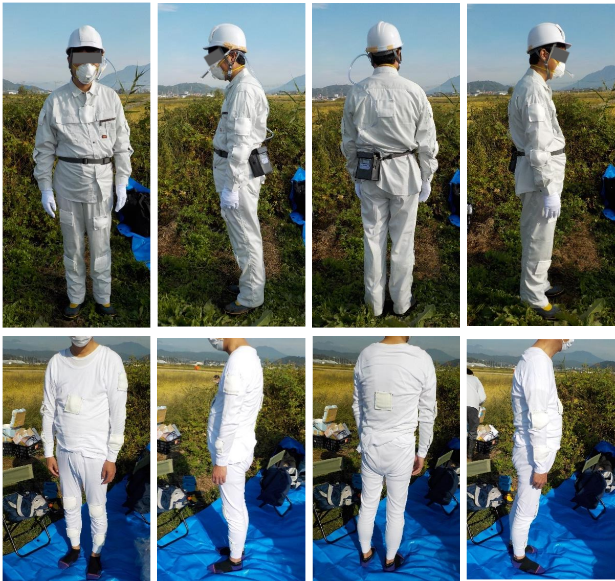
図 12 操縦者・補助者の身体表面暴露量調査 調査装備
