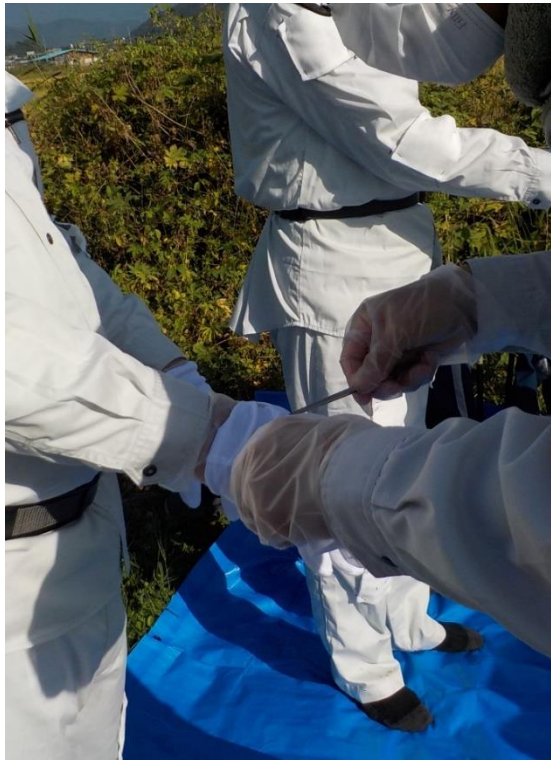
図 14 操縦者・補助者の身体表面暴露量調査 手(手袋)試料回収
