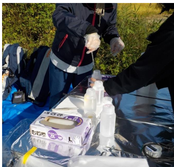
図 16 操縦者・補助者の身体表面暴露量調査 インナーガーゼパッチ試料回収
