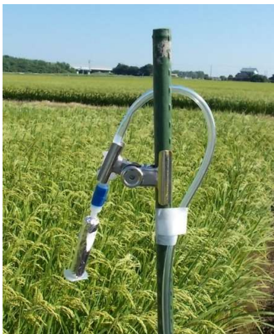
図 17 吸入暴露量調査(左：捕集カラム、右：設置状況)
