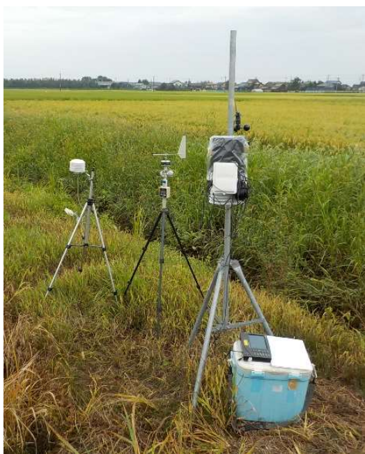
図 18 気象観測 (左：気象観測装置、右：吹き流し)
