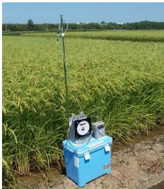
図 17 吸入暴露量調査(左：捕集カラム、右：設置状況)
