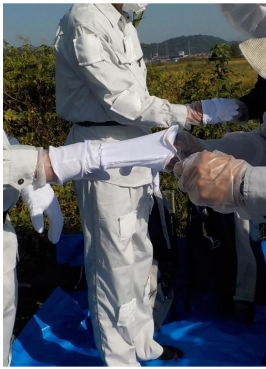
図 14 操縦者・補助者の身体表面暴露量調査 手(手袋)試料回収
