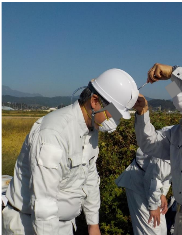
図 13 操縦者・補助者の身体表面暴露量調査 頭(ヘルメット)試料回収
