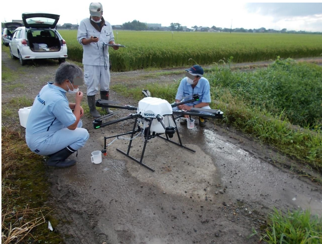
図 57 吐出量の測定状況
