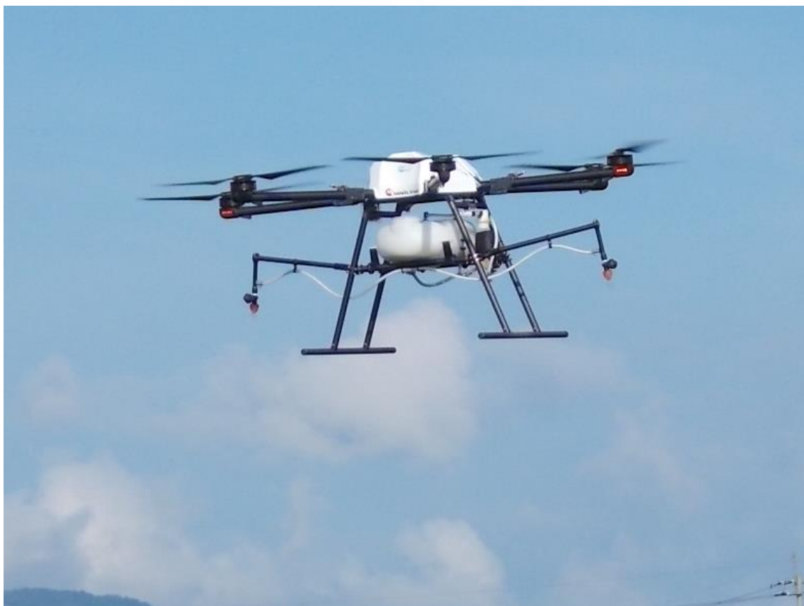
図 56 散布機器（丸山製作所社製ドローン 型式：MMC1501）
