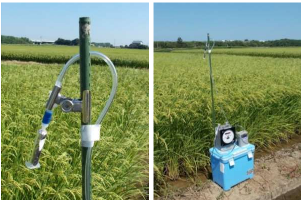
図5 吸入暴露量調査(左：捕集カラム、右：設置状況)
