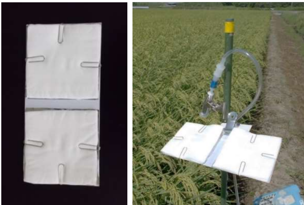
図4 身体表面暴露量調査(左：調査用ガーゼパッチ、右：設置状況)
