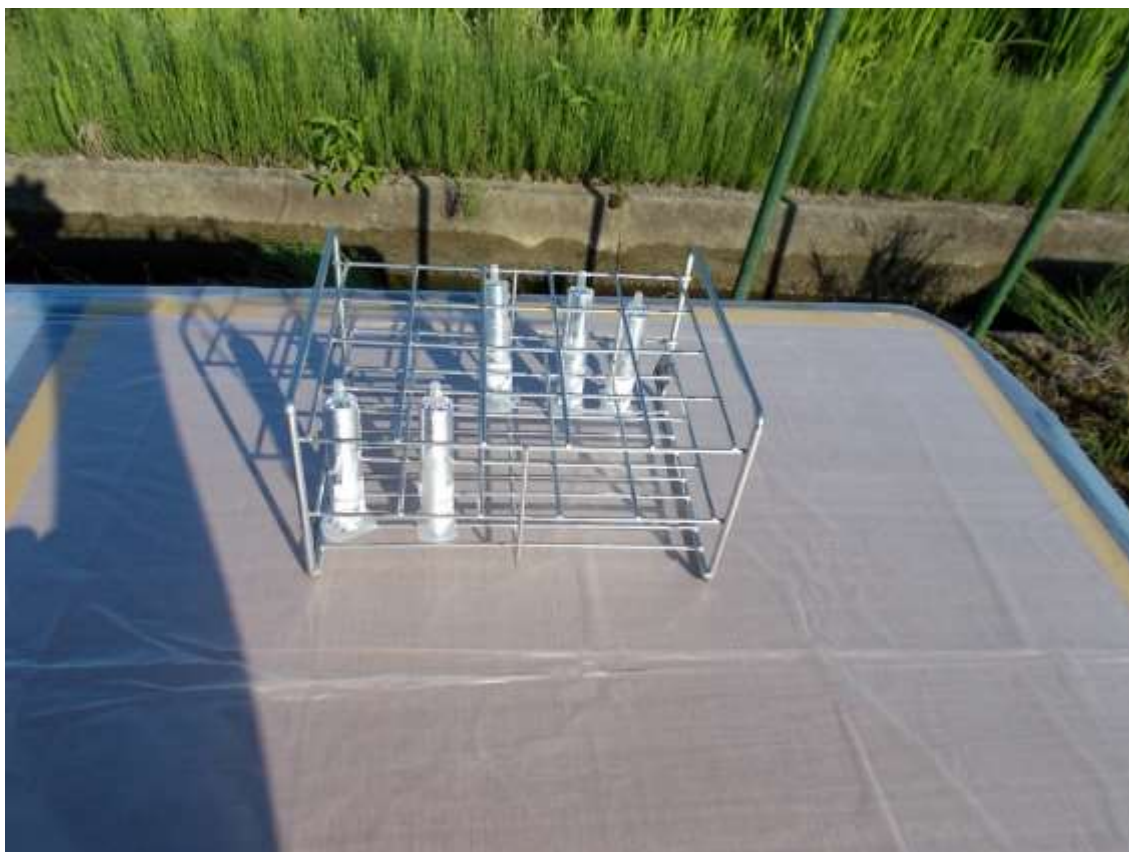
図 63 野外添加回収試験状況 捕集コラム設置
