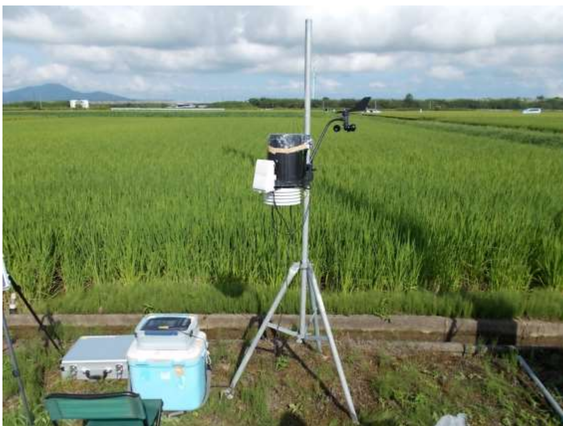
図 54 気象観測装置 自動記録計(気温・湿度・風向・風速)
