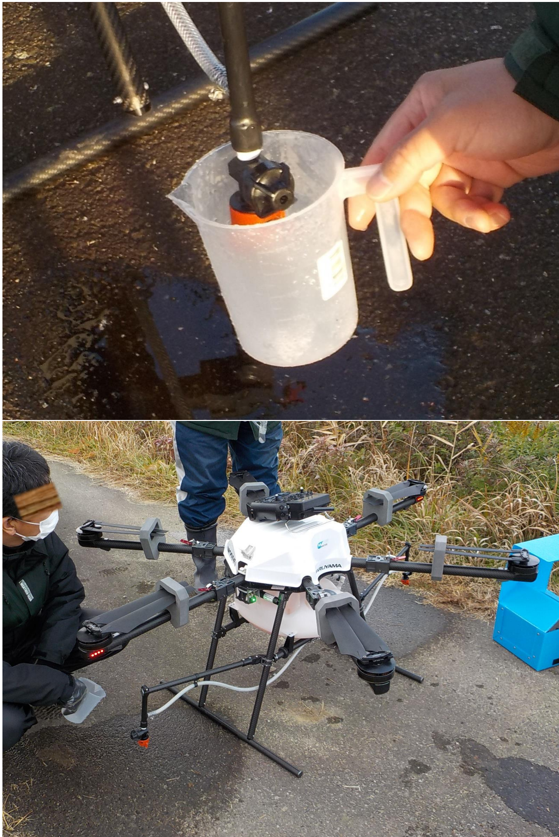
図 59 吐出量の測定状況
