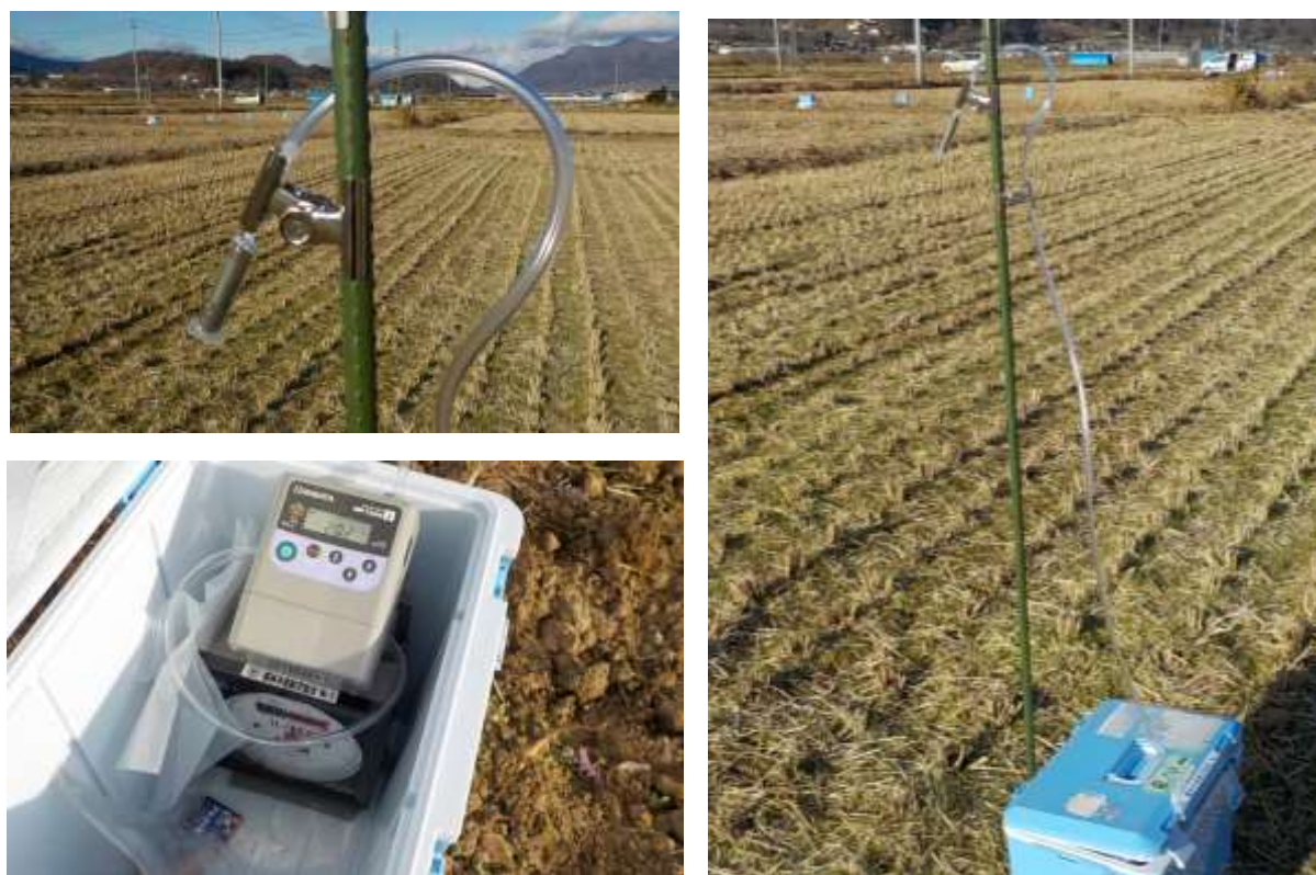
図5 吸入暴露量調査(左上：捕集カラム、左下：捕集装置、右：設置状況)
