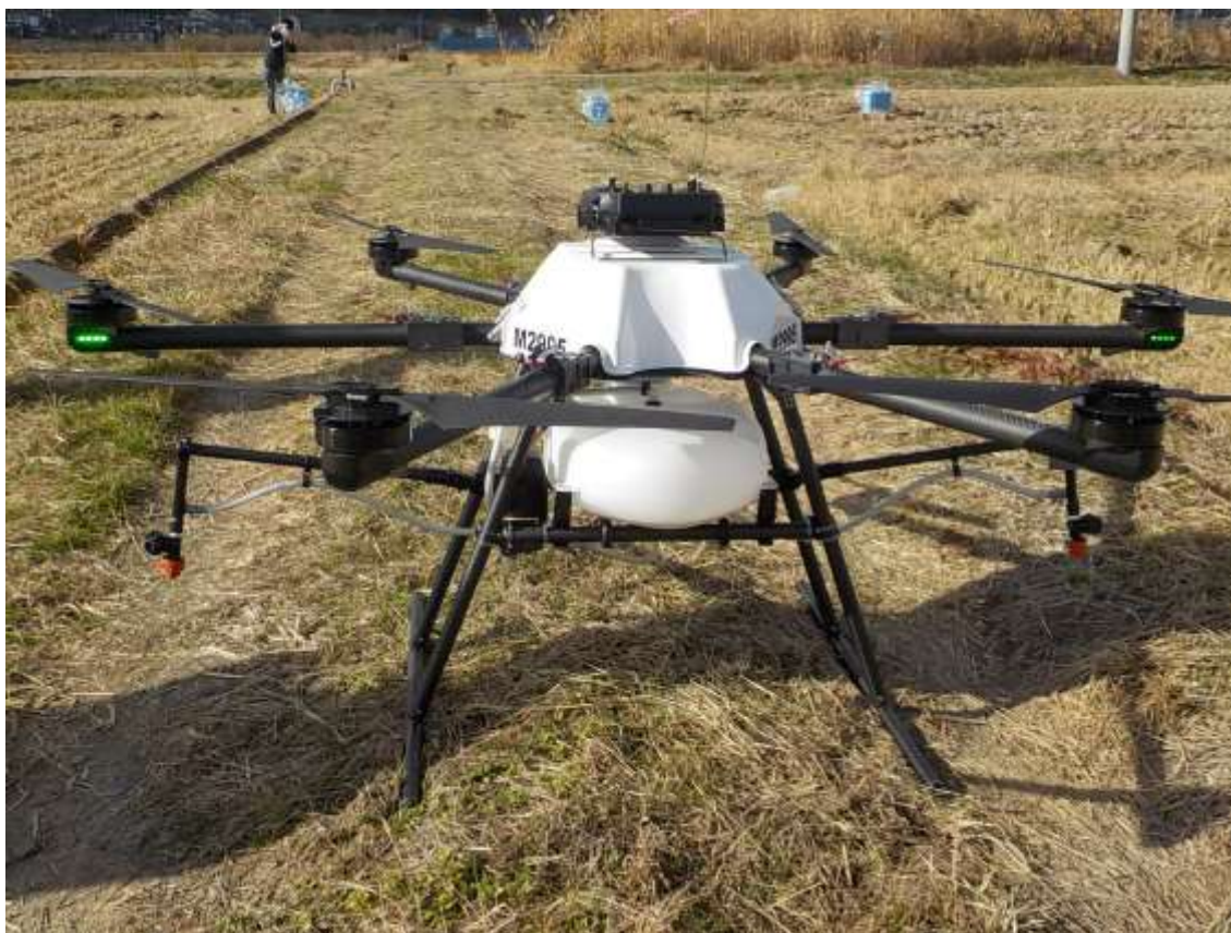
図 58 散布機器(丸山製作所社製ドローン 型式：MMC1501)
