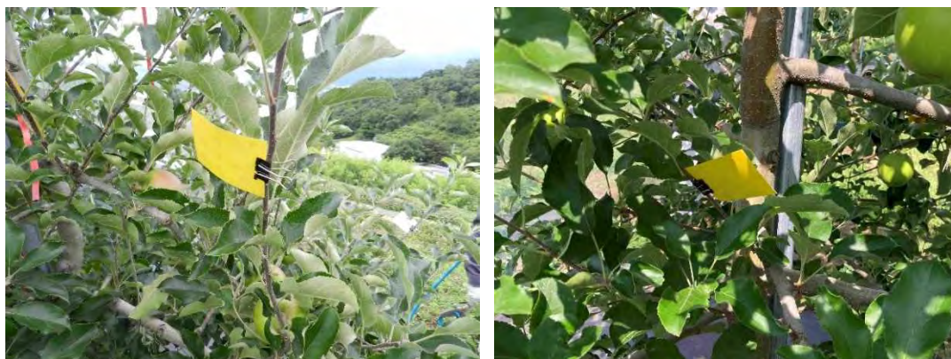
図 20. 感水紙設置の様子(左:樹冠外側、右:樹冠内側)
