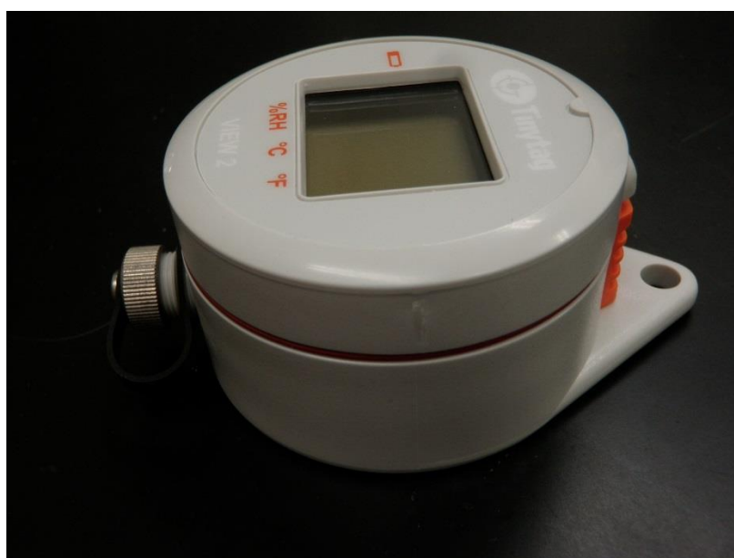
写真 8 温湿度記録機器（Tiny tag 社製、Tiny tag view2）
