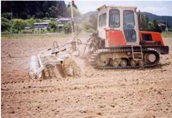
(レーザーレベラーによる均平作業)
