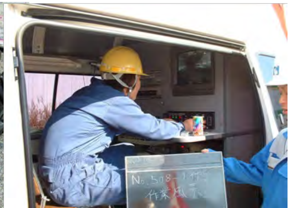
写真-5-4 二次調査（管内カメラ調査）器具と状況
