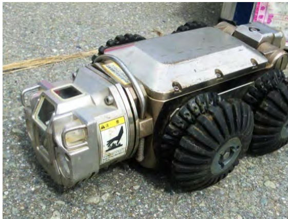
写真-5-4 二次調査（管内カメラ調査）器具と状況
