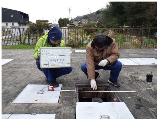
写真 3-3-5. 界面検知器を用いた堆積汚泥厚測定状況
