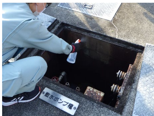
写真 3-3-7. フェノールフタレイン試薬の散布状況
