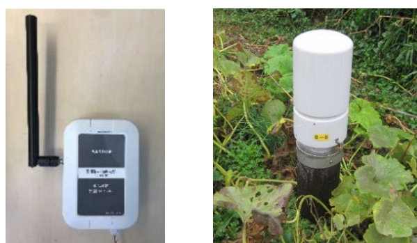
写真 4 - 3 - 1. 真空弁向け監視端末の例
