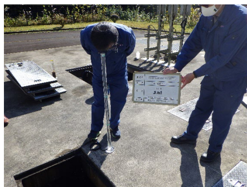
写真 3 - 3 - 3. 透視度測定状況
