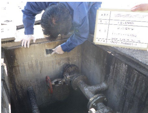
写真 3 - 3 - 6. pH 測定状況（左：サンプル採取 右：pH 計）
