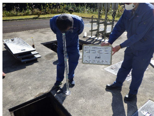
写真 3 - 3 - 3. 透視度測定状況
