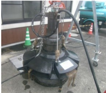
写真 1－3．省エネルギー技術の導入（微細気泡散気装置の導入）
