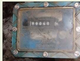
カウンタ付きの場合には、弁の開閉作動回数を確認
