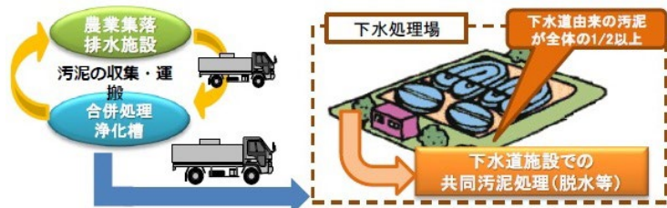
図 2-19 汚泥の共同処理
