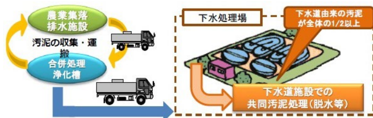
図 2-19 汚泥の共同処理
