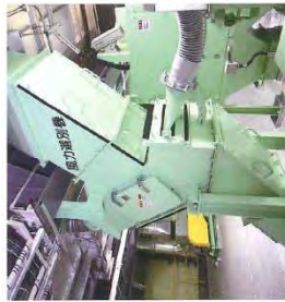
● 風力選別機 風のかで軽いごみと重い鉄を選別します。
