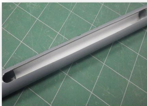
写真－1.6.13 方眼紙を添付した硬質塩化ビニルパイプ
