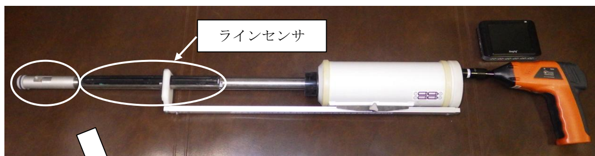
写真－1.6.11 紫外線ライト型計測装置
