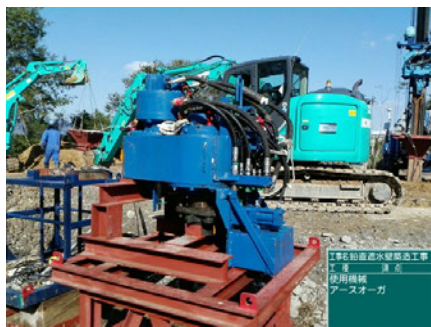
アースオーガー (掘削トルク 17.3~101.8kN・m)
