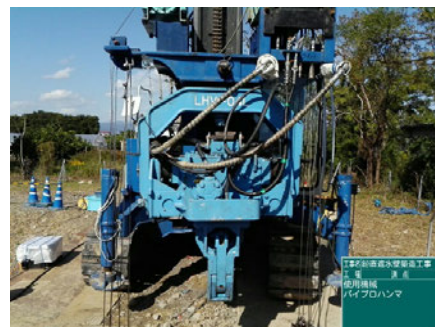
バイブロハンマー (起振力 61.3~92.2kN)
