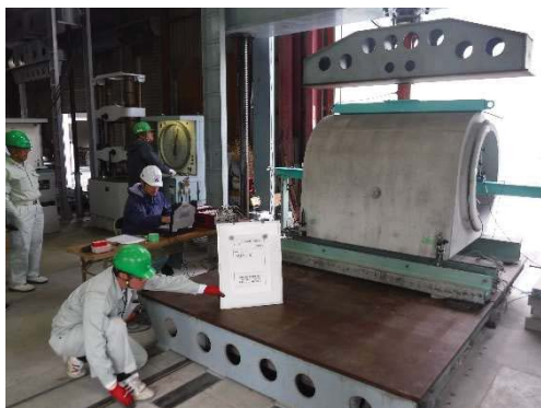
写真1 ブロック性能確認試験状況
