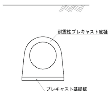
図-3.1.1(2) 耐震性プレキャスト底樋 断面図
