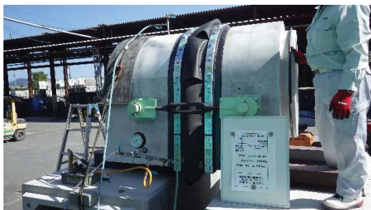
写真 7 抜け出し状態（拘束部）試験状況
