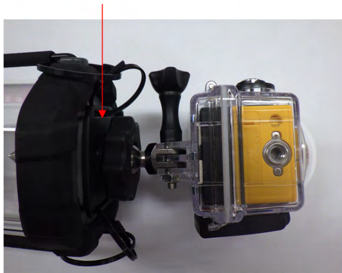
図 6-8 ランタンへの全方位カメラの取付
