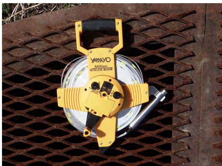
図 6-9 水位計(ミリオン水位計 WL50M)
