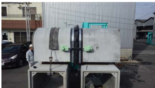
写真 14 抜け出し状態（標準部）試験状況
