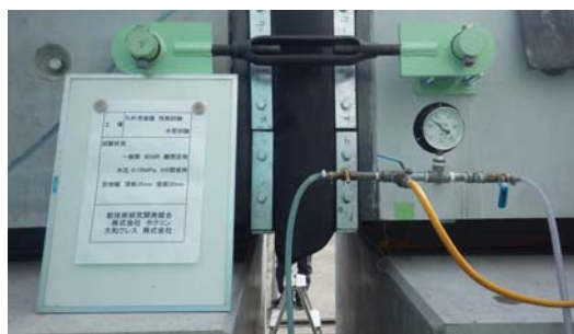
写真 15 抜け出し状態（標準部）0.15MPa
