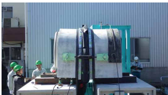
写真 22 屈曲状態（拘束部）試験状況
