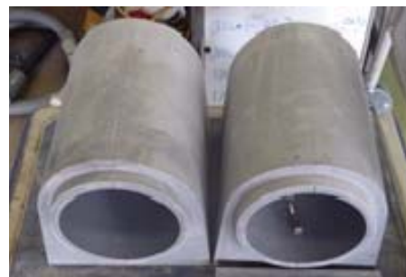
写真24 底樋ブロック
