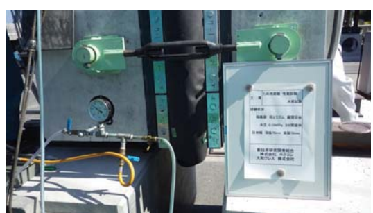
写真 21 抜け出し状態（拘束部）0.15MPa
