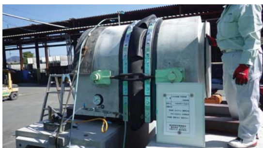
写真 20 抜け出し状態（拘束部）試験状況
