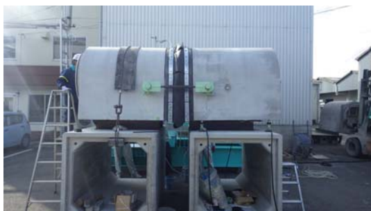
写真 16 屈曲状態（標準部）試験状況
