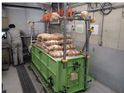
写真8 土嚢設置状況
