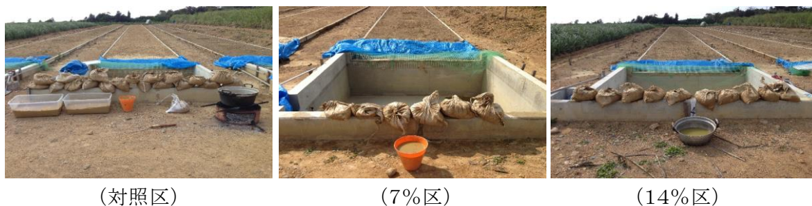
図2. 3 流出土の回収状況
