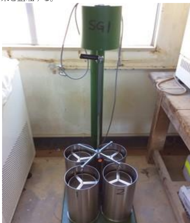
図 1. 4 耐水性団粒試験に使用する試験装置（大起理科工業株式会社，土壤団粒分析器 DIK-2001，フルイ（JIS Z 8801）は 5 段組で，各フルイの呼び径は上から順に 2・1 mm と 500・250・106 μm）
