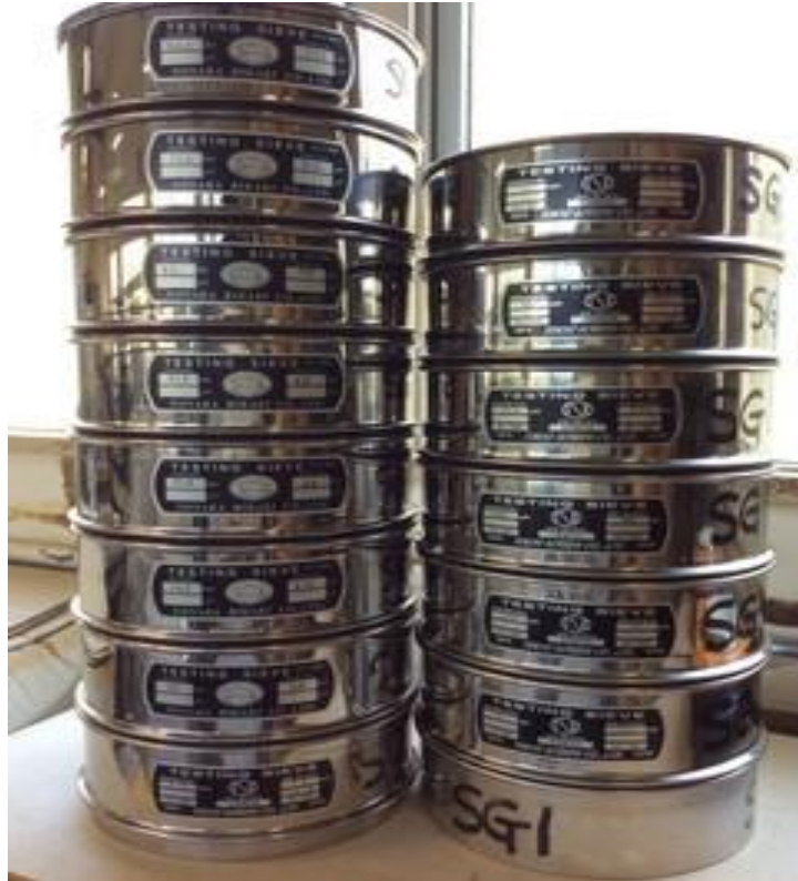
図1. 1(土塊分布試験に使用するフルイ一式)
