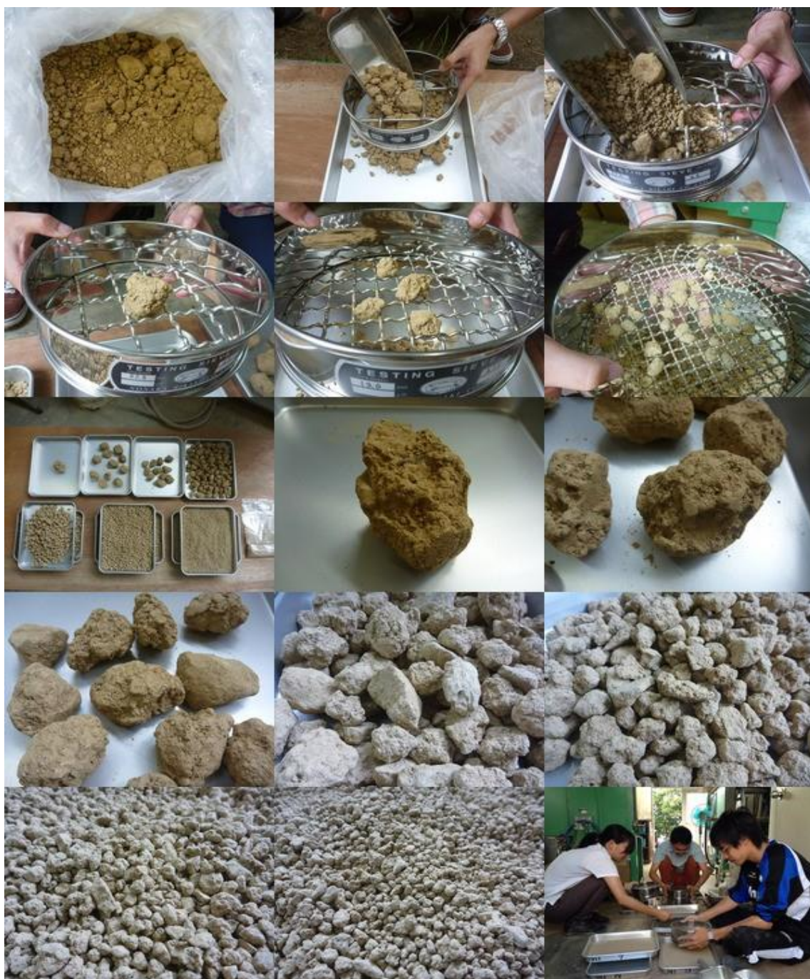
図1. 2(土塊分布試験の様子)
