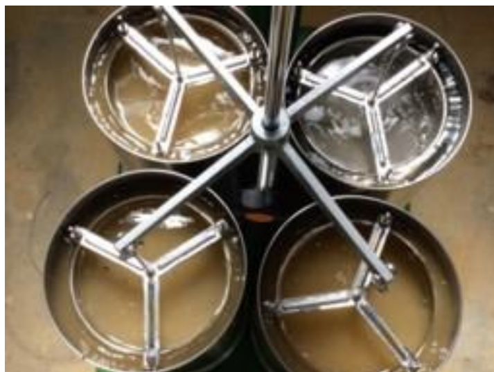
図1. 5 耐水性団粒試験中の円筒水槽内の貯水の濁り (右上の円筒水槽は 7%試料, それ以外の円筒水槽は 0% 試料)
