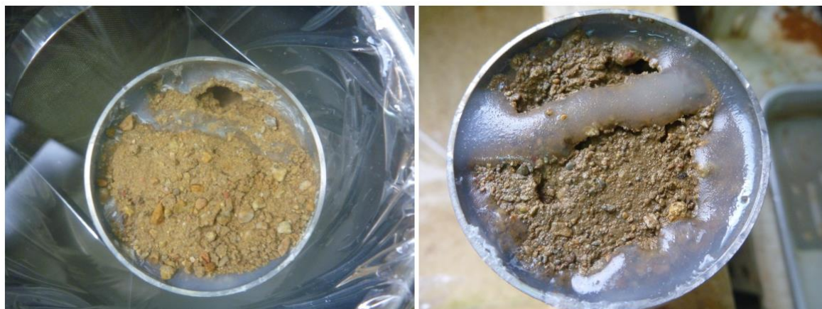
図2. 6 供試による表層クラストの破損状況
