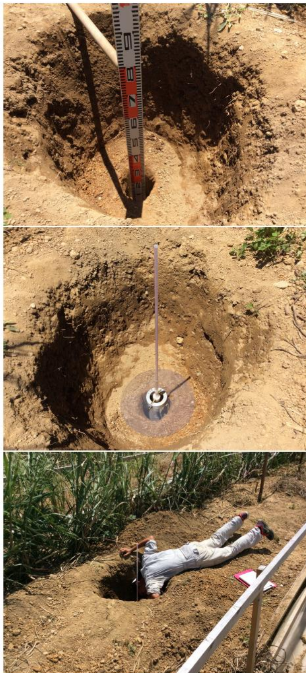
図2. 7 長谷川式簡易現場透水試験器を用いた心土層の原位置透水試験の実施状況(上段:心土層の掘削、中段:水位計の設置、下段:測定値の読み取り)
