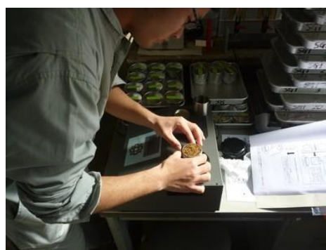
図2. 2 実容積の測定(大起理科工業株式会社, デジタル実容積計 DIK-1150)
