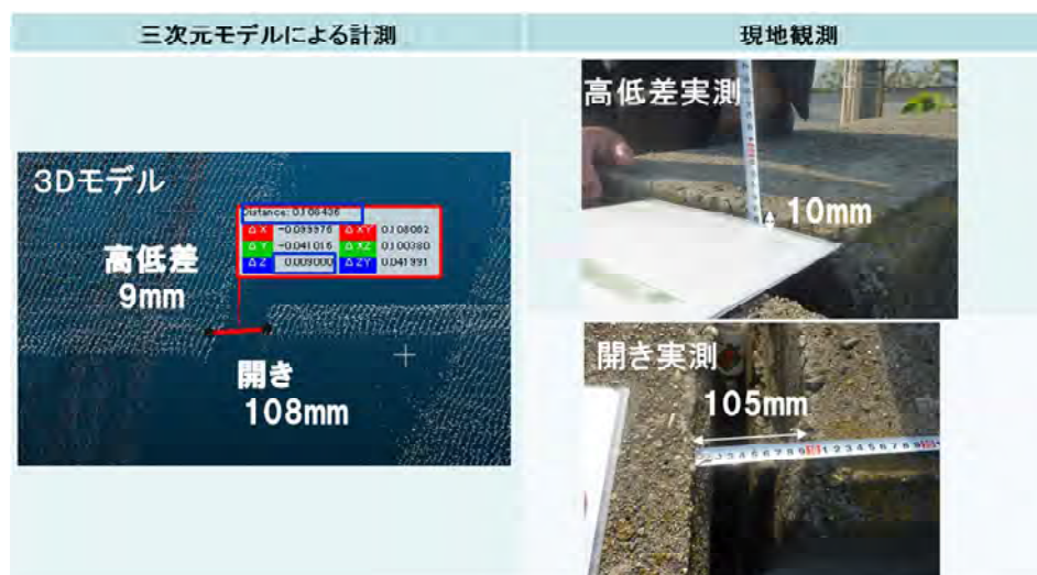
図 2-9 (3) 三次元モデルの計測による目地の開き・高低差の把握
