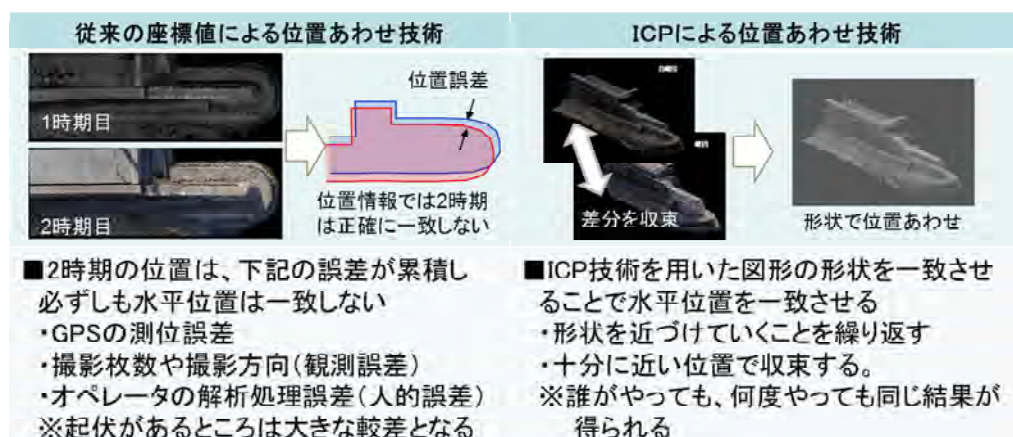
図 2-10 従来の位置あわせと ICP 技術による位置あわせの特徴
