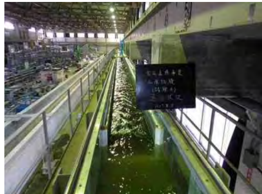
写真 2.2 水位計による水深測定状況
