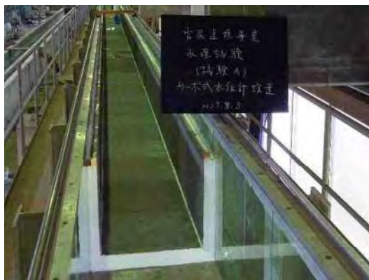
写真 2.1 模型水路の製作状況
